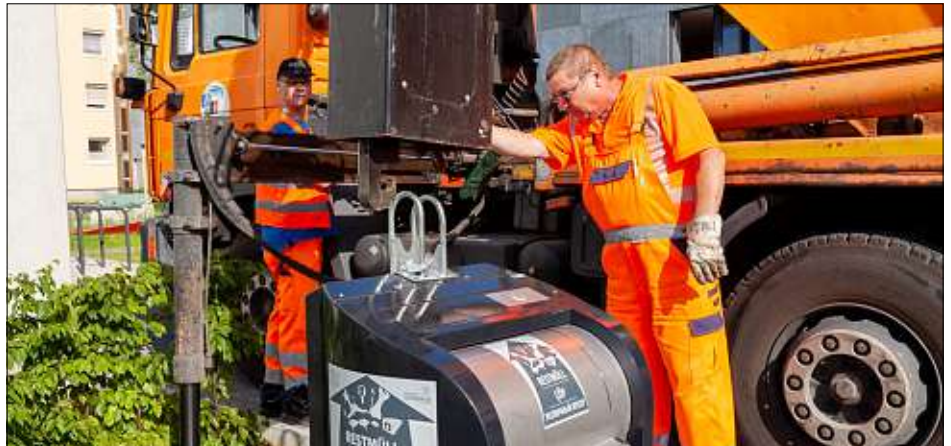
Seit 2018 testen die Kommunalbetriebe zusammen mit der Gemeinnützigen Wohnungsbau-Gesellschaft Ingolstadt (GWG) bei mehreren Wohnanlagen erfolgreich den Einsatz von Unterflursystemen. Weitere Standorte, auch mit anderen Gesellschaften, sind in Planung. Foto: Hammer
